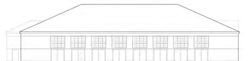
Sydfacade med nye fløjddøre i stueetagen
